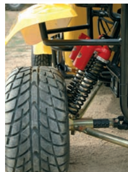
La suspensión trasera cuenta con doble amortiguador por rueda.
