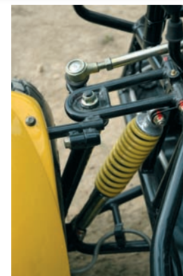
La suspensión trasera cuenta con doble amortiguador por rueda.
